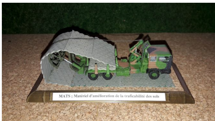
Le MATS permet de déployer une tapis sur le sol afin de permettre le passage d'engins très lourds (Chars, Gillois, Semi-remorque,...)
